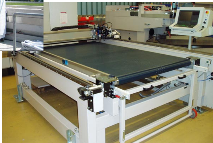
Toepassing als drager in vacuümtafel
